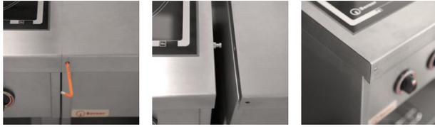
Flächenbündiges Verbindungssystem mit hygienischer Haarfuge. Abdeckung seitlich scharfkantig ausgeführt. Seitenflanken mit Bolzen und Bohrungen für integrierte Zugschiene. Geräte können mit 6-kant Schlüssel fest verbunden und wieder gelöst werden.
