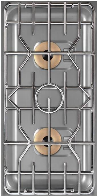
Ausführung in AISI 304 (Chromnickelstahl 18/10 DIN 1.4301), tiefgezogene Kochmulde (ca. 65 mm) zur leichten Reinigung. Zündflammenbrenner mit Pilotflamme, Gasrampe mit Gasbrennregler und abnehmbarer Schieberrost über der Kochstelle.
