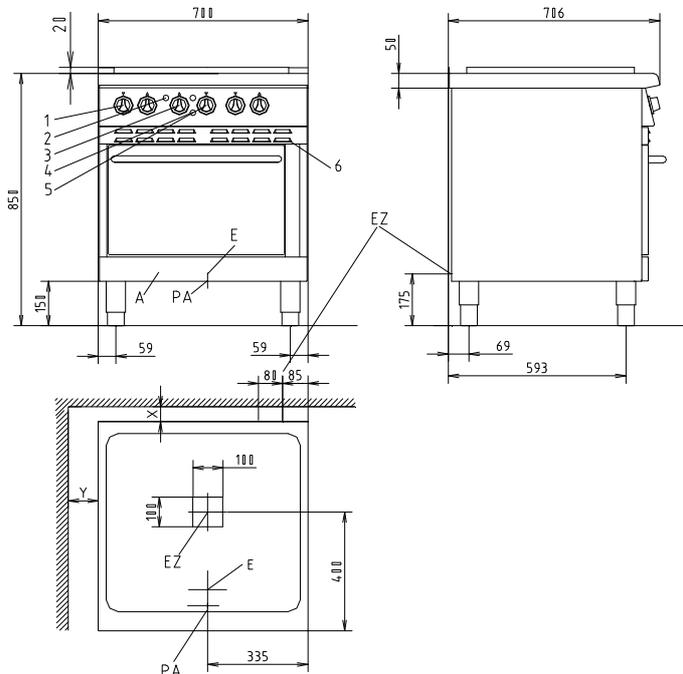
Alle Bemaßungen für Medienanschlüsse beziehen sich auf die Außenkante der Abdeckung!
