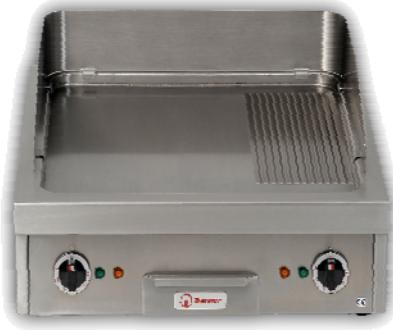
Gehäuse Werkstoff: CNS 18/10 DIN 1.4301, Platte hartplattiert, Grundmaterial Stahl Stärke 12 mm, Auflage-werkstoff Spezial CNS 3 mm, Ecken gerundet, R12, mit Spezialschliff für eine gute Antihaftwirkung. Vorne mit Ablaufschacht (130 x 40 mm) in Fettschublade.
